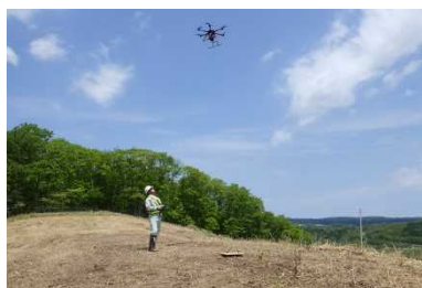
UAVを用いた航空写真 測量
