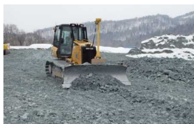
MCブルドーザによる 土砂掘削
