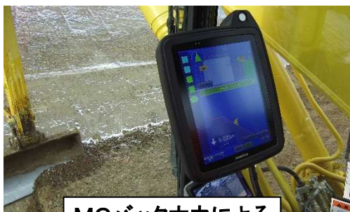
MCバックホウによる掘削状況(オペレーター目線)
