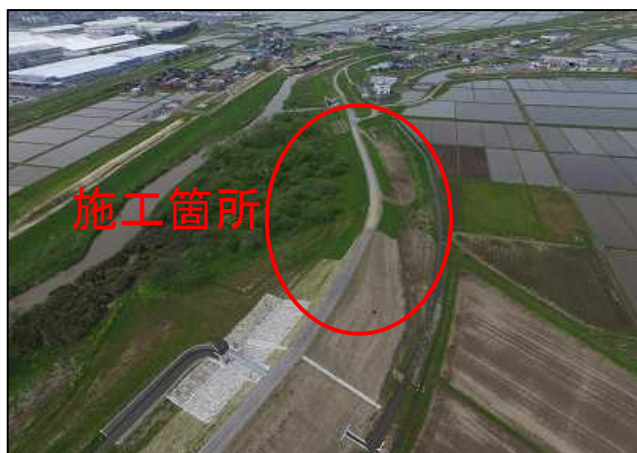
UAVによる施工前の空中写真測量
