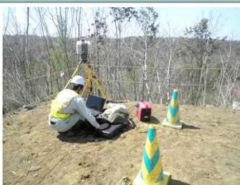
レーザースキャナーによる計測 (上空視界不良範囲)
